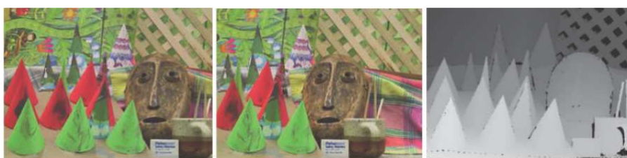
Rys. 5.3. lewy obraz (po lewej) i prawy obraz (w środku) oraz odpowiadająca im mapa głębi (po prawej)
